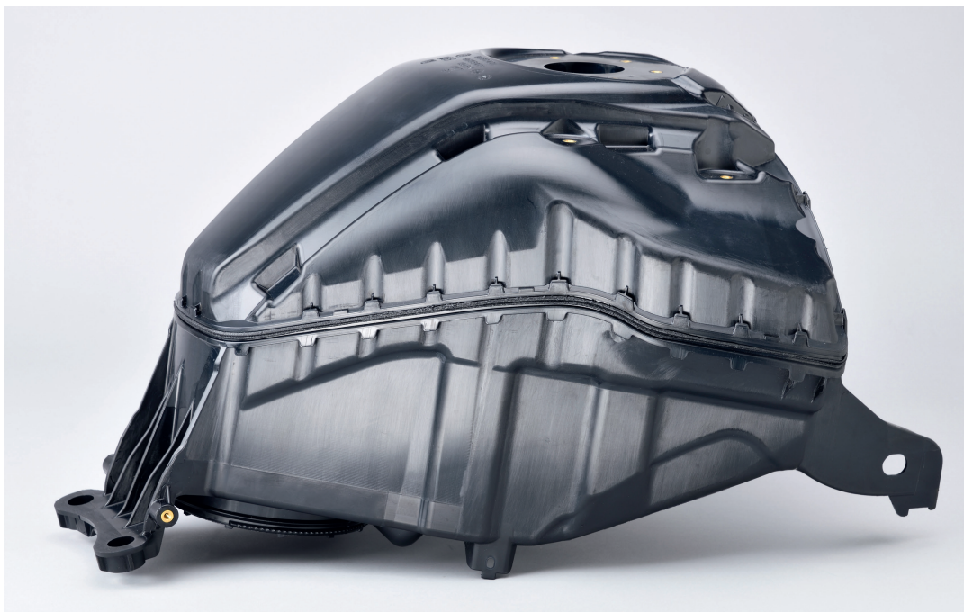
Motorradtank aus Durethan BC550Z 900116 DUSXBL: Das unverstärkte und schlagzäh modifizierte PA 6 wird zu zwei Halbschalen spritzgegossen, die durch Heizelementschweißen zum Tank gefügt werden © Lanxess
